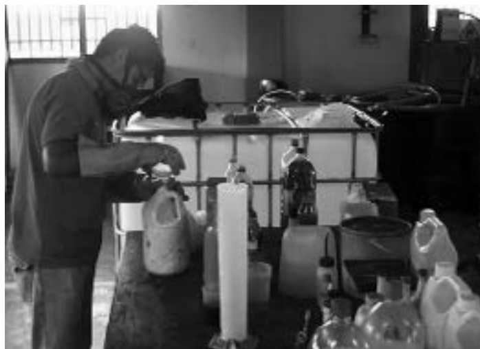
Imagen 2. Estudiante del Cever (Centro de Educación Vocacional Evangélica y Reformada) trabajando en la esterificación de los químicos requeridos para esterificar el aceite vegetal virgen y convertirlo en biodiésel
