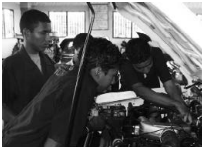
Imagen 3. Estudiantes del Cever adaptando un motor de diésel para que funcione con aceite vegetal de semillas de jatrofa
